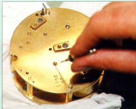
**9** Au sommet de la platine supérieure, sont réinstallés toute la partie minuterie et le système de déclenchement de la sonnerie. Cet assemblage est maintenu en position par la pose de la contreplaque sur laquelle vient se placer le cadran. A l'aide d'une minuscule burette-seringue (le "pique huile"), quelques gouttes d'huile sont déposées, pour limiter les frottements, partout où les métaux sont en frottement, c'est-à-dire essentiellement à la base des pivots.
