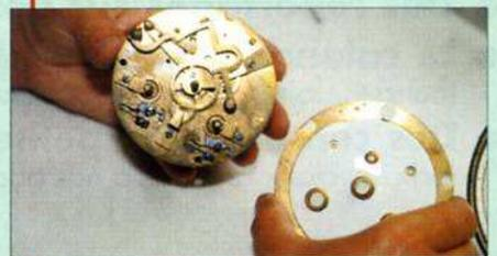
**3** La coupelle du timbre est démontée. Puis, à l'aide d'une pince, l'horloger extrait les trois goupilles qui maintiennent le mouvement sur la face avant. Le cadran émaillé est désolidarisé avec précaution. Le démontage se poursuit par l'extraction de la roue à canon, de la chaussée, donc de toute la partie "minuterie", ainsi que du système de déclenchement de la sonnerie.
