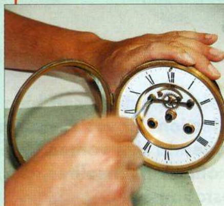
**2** Les ressorts du mouvement et de la sonnerie sont désarmés, pour éviter qu'ils ne se libèrent brutalement pendant l'intervention, au risque d'endommager des pièces. L'opération de désarmement se fait en maintenant une clé dans l'axe du remontoir et en détendant peu à peu celui-ci. L'action suivante consiste à désolidariser l'ancre, visible en partie haute du cadran.
