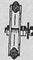
Abb. 204b Vorderrad des Kranes im Schnitt (der Autoreifen ist zwischen zwei Loch- scheiben eingeklemmt).
