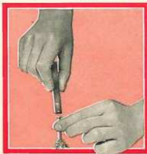
Fig. 6. Tenue à proximité d'un des pôles du Barreau Aimanté, un clou devient temporairement aimant.
