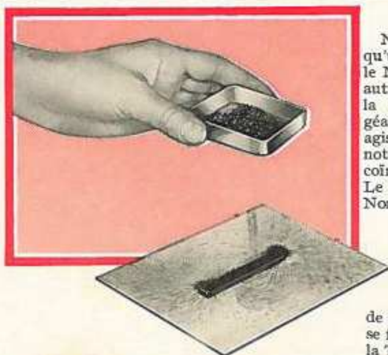
Fig. 11. On agite légèrement la petite boîte à fond perforé au-dessus de la feuille de carton, afin d'y répandre uniformément la limaille.
