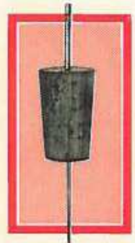
Fig. 22. Aiguille aimantée et bouchon employés pendant les expériences avec l'aimant flottant.
