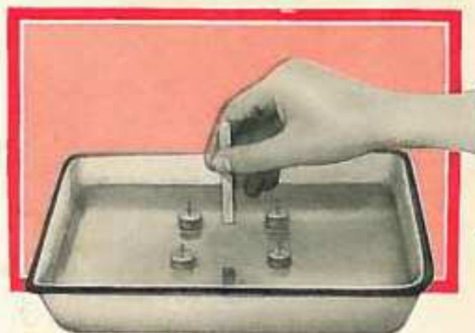
Fig. 23. Les quatre aimants flottants forment les quatre coins d'un carré régulier.
