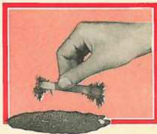
Fig. 2. La force d'attraction de l'aimant est concentrée sur ses pôles.
