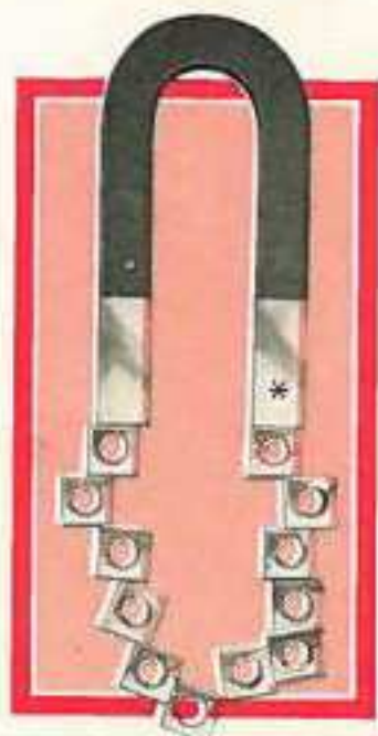
Fig. 5. Chapelet d'écrous formé par l'attraction de l'aimant.
