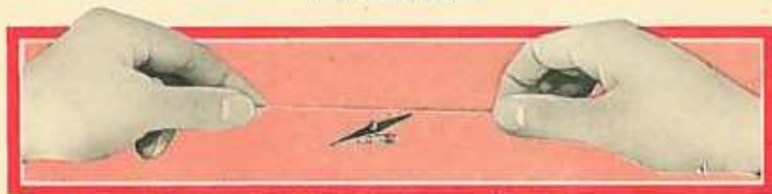
Fig. 11. Une aiguille aimantée dévie de sa position normale si l'on tient au-dessus d'elle un fil connecté aux bornes de la Pile au Bichromate.
