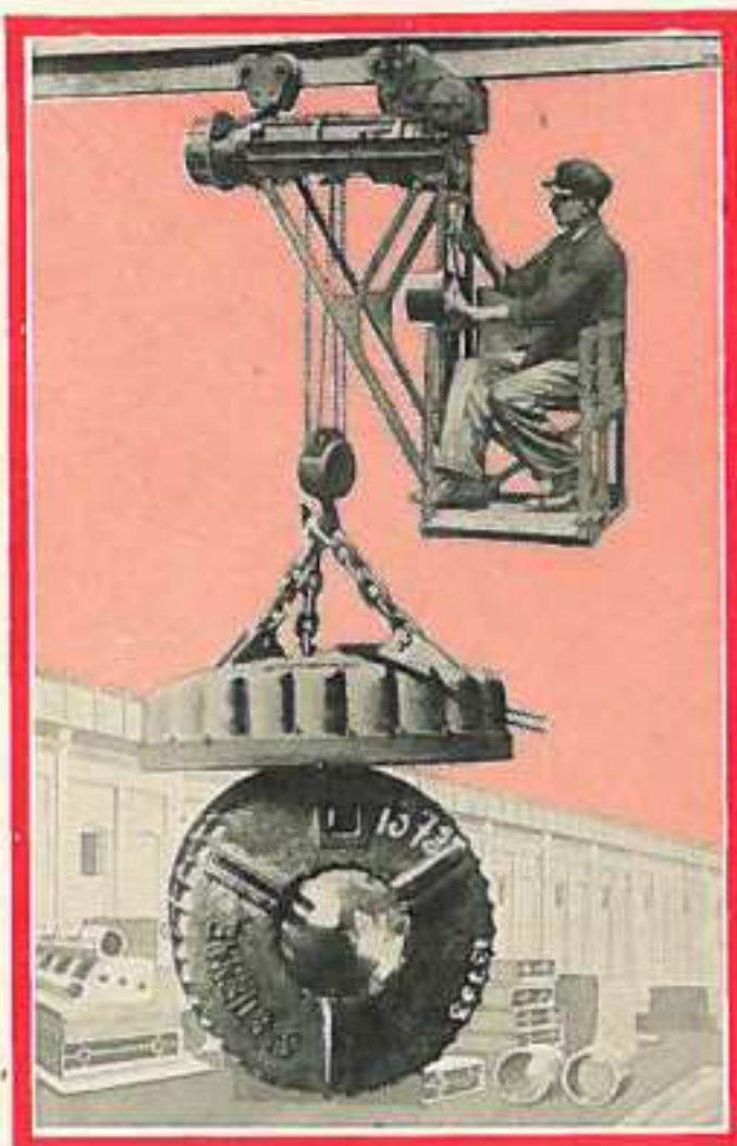
Fig. 21. Grue électro-magnétique à l'œuvre.
