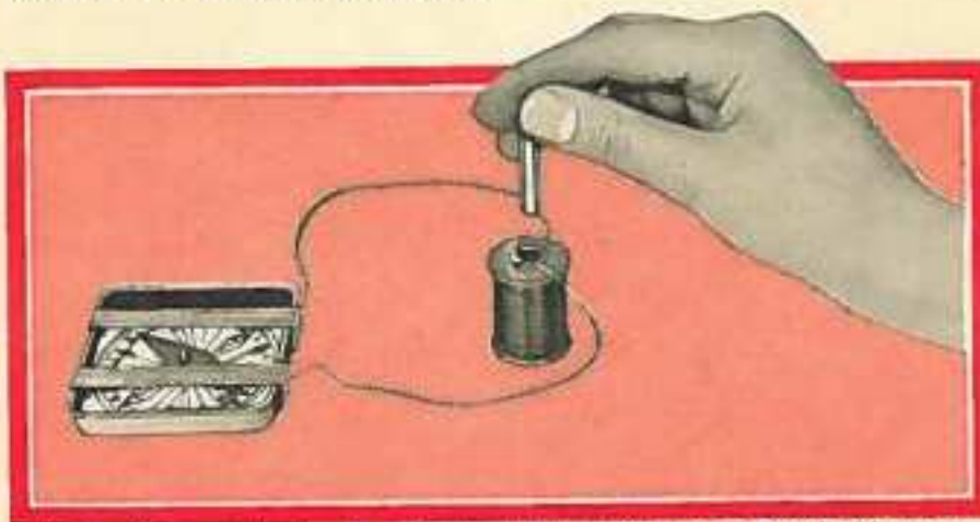
Fig. 27. En approchant un des pôles d'un Barreau Aimanté de l'extrémité du Noyau de l'électro-aimant on induit un courant dans la bobine.
