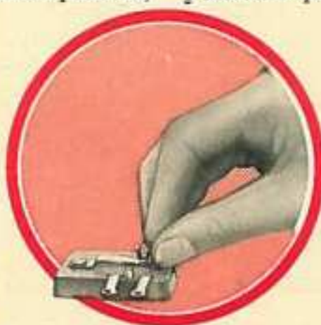
Fig. 25. Interrupteur Elektron employé comme manipulateur télégraphique.
