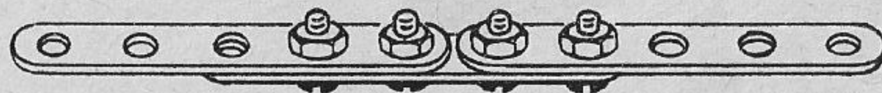
B 2 - Stoßverbindung zweier Flachbänder
