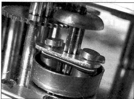
▲ Régulateur d'un moteur Märklin N° 202 de 1920. ▼ Le régulateur d'un moteur Stokys de 1960 utilise un principe analogue mais les masselottes tournent dans un tambour.
