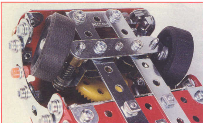
▼ 5 : Vue rapprochée de la direction et de la suspension avant.
