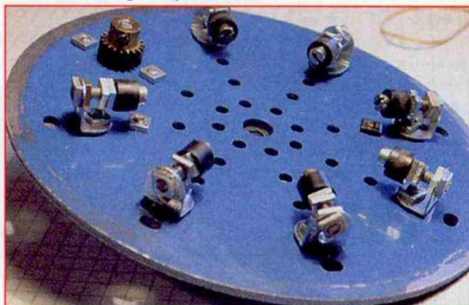
▼ 13 : Position des galets après rotation.
