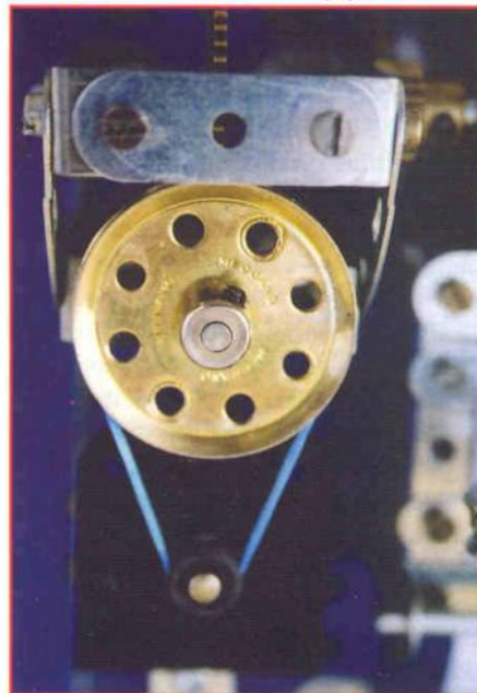
▲▼ 1 & 2 - Zone 6 : Guide de bande papier, zone 5 - Mécanisme d'avancement du papier.
