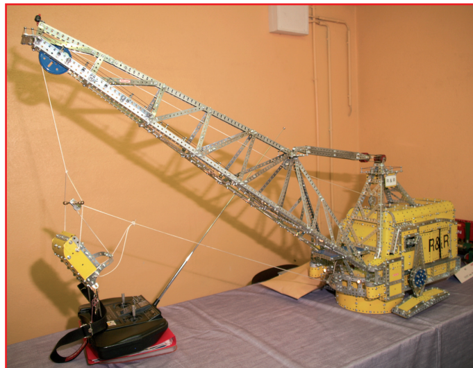
Dragline marcheuse construite d'après les plans anglais de MW : Le modèle reprend les formes et caractéristiques extérieures de la machine, mais avec une mécanique JP. Un seul moteur entraîne toutes les fonctions qui sont assurées par un boîtier de commande à distance. Chaque fonction est commandée par un moteur Meccano noir réf. 700. Les modifications apportées feront l'objet d'un futur article pour le magazine du CAM.
