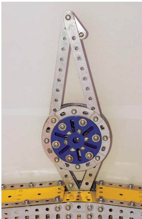
Photo 5 : le bras de manivelle double est fixé au point le plus bas du patin.
