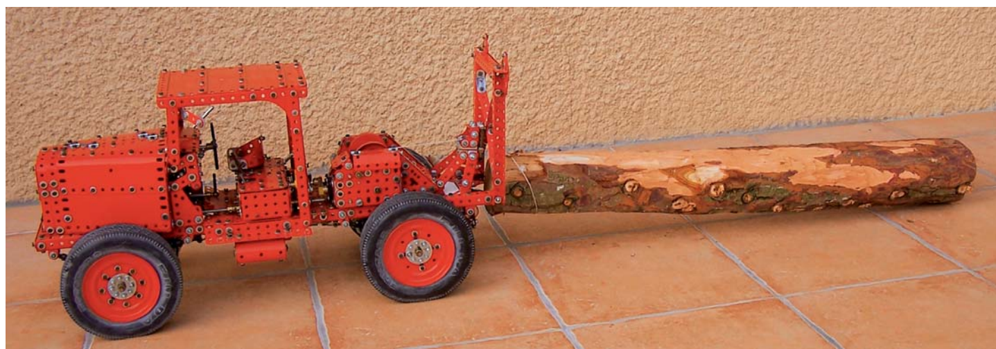
Au travail, la bille de bois est maintenue d'un côté par le treuil du LATIL ; l'autre côté de la bille traîne sur le sol.
