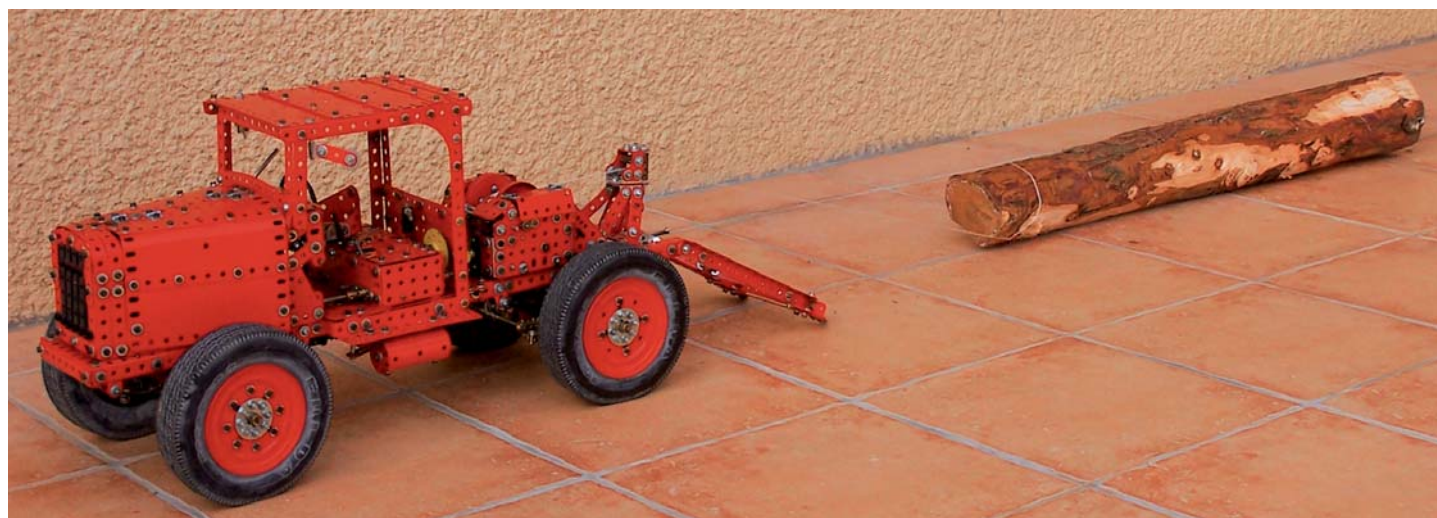
Position travail. La bêche est posée sur le sol et le câble attaché à la bille de bois.
