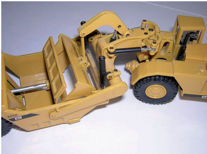
Notez les six vérins : direction gauche, direction droite, deux vérins pour baisser la benne, ouverture de la benne, en gris métal vidange de la benne.
