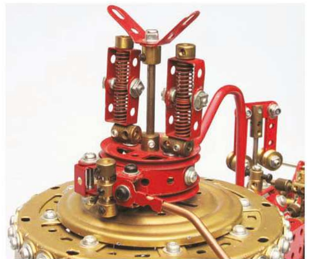
Fig. 6 Soupapes de sécurité, levier de commande et conduite de vapeur à l'arrière
