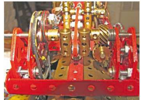
Fig. 11 Vue de l'axe principal du vilebrequin avec poulie d'entraînement, excentrique et pignon hélicoïdal
