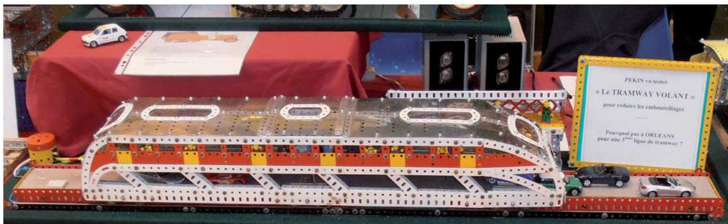
Le tramway "volant" de Pékin : rouler en voiture sous le tramway pour réduire les embouteillages.
