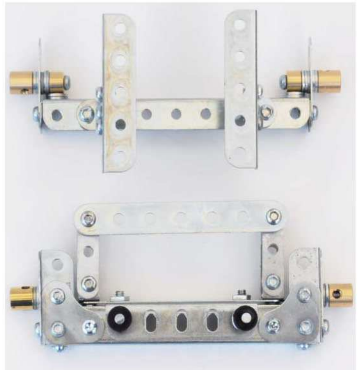
DIFFÉRENTES VUES DE L'ADAPTATION DE LA DÉMULTIPLICATION SUPPLÉMENTAIRE ET DE L'ADJONCTION D'UN DEUXIÈME PONT ARRIÈRE
