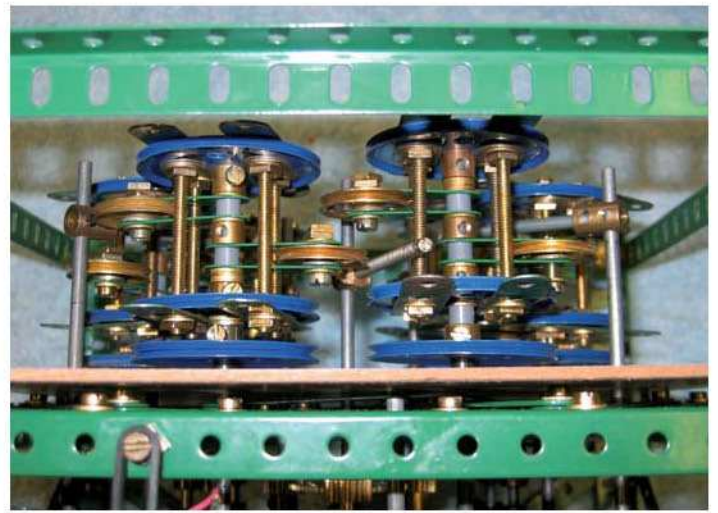
Figure 7 Leviers de commutation pour les têtes porteuses intermédiaires
