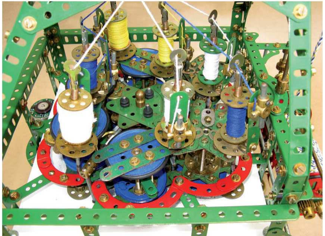
Figure 8 Montage des bobines sur les têtes porteuses
