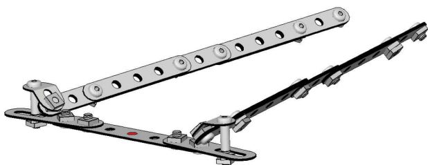
Fig 7 : l'ancrage des barres de torsion au châssis
