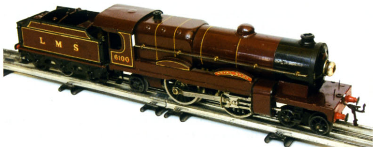
Une "Royal Scot" de 1934 sans pare-fumées. L'immatriculation est dorénavant placée sur le flanc de la cabine, à la place du monogramme de la Cie, sauf pour le SR (voir en bas de page).
