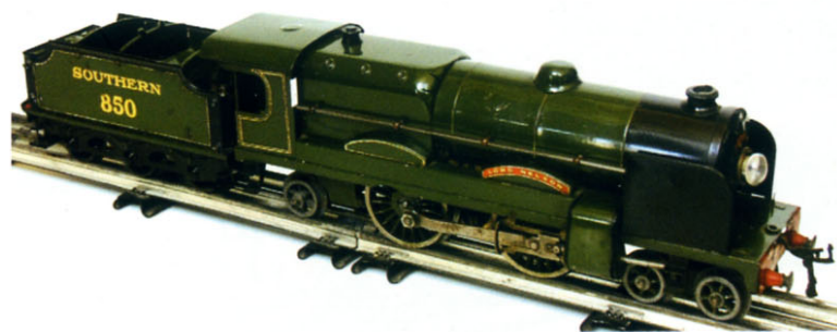
Une "Lord Nelson" de 1936 avec pare-fumées. Immatriculation 850 sur le tender (E850 sur les N°2 et N°3 antérieures à 1934). Notez la forme des pare-fumées spéciaux que nous retrouverons sur les "Eton".
