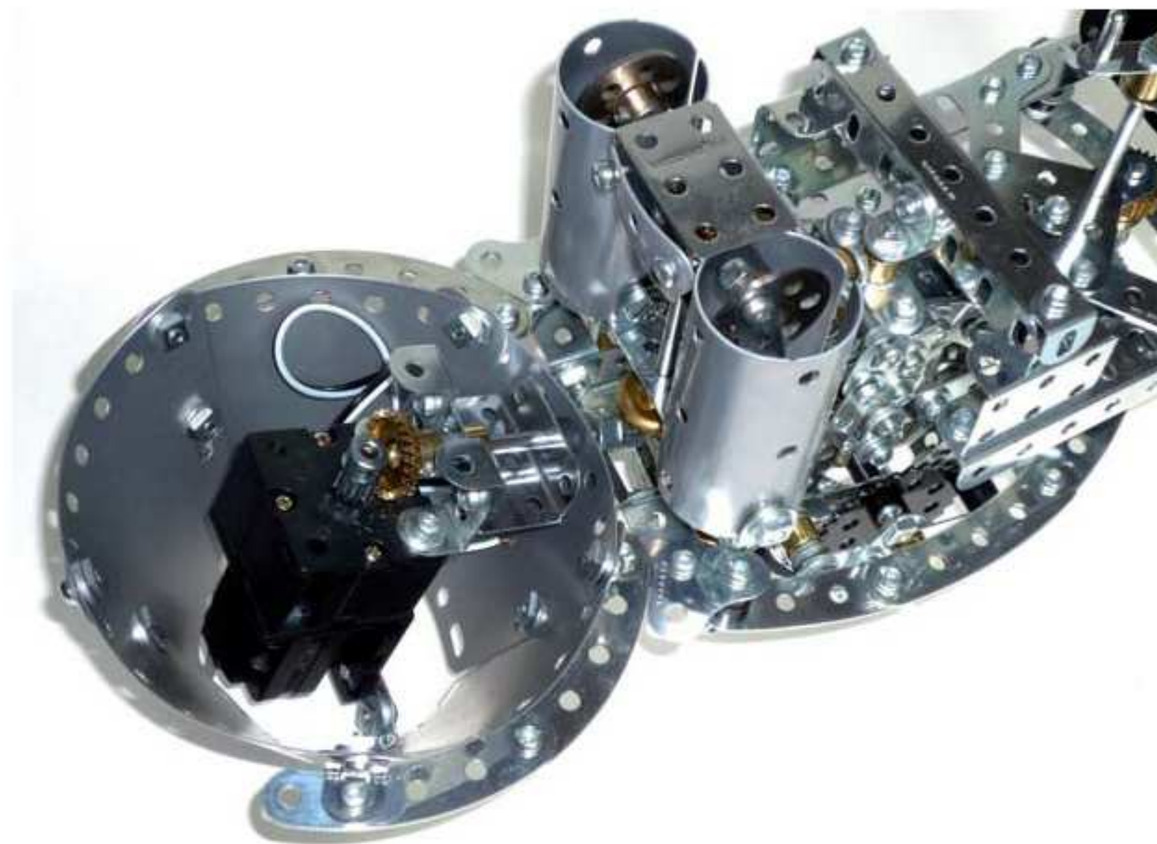
La cuve ouverte fait apparaître le moteur et son réducteur
