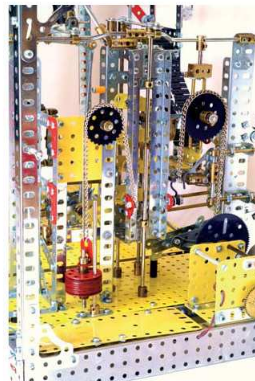
Photo 3 - L'entraînement de l'ascenseur 1. A gauche, le contrepoids servant à réduire les contraintes du moteur.
