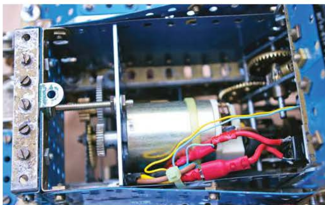
Photo 8 : le moteur 24 volts
