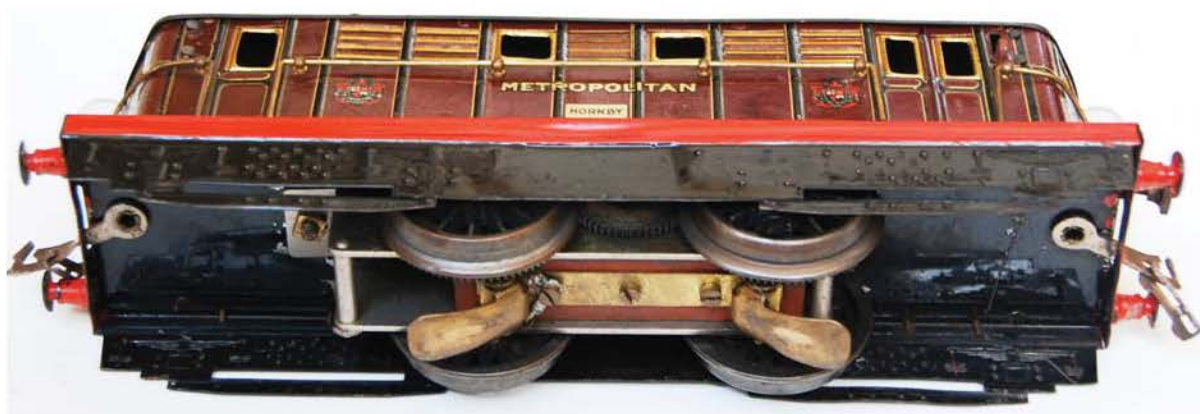
Les dessous de la belle dévoilent sans pudeur la supercherie, ici avec un moteur 6 volts de la période 1929.
