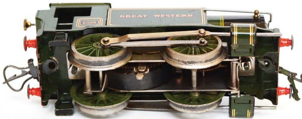
Platine mécanique avec arrêt et renversement par la voie.
