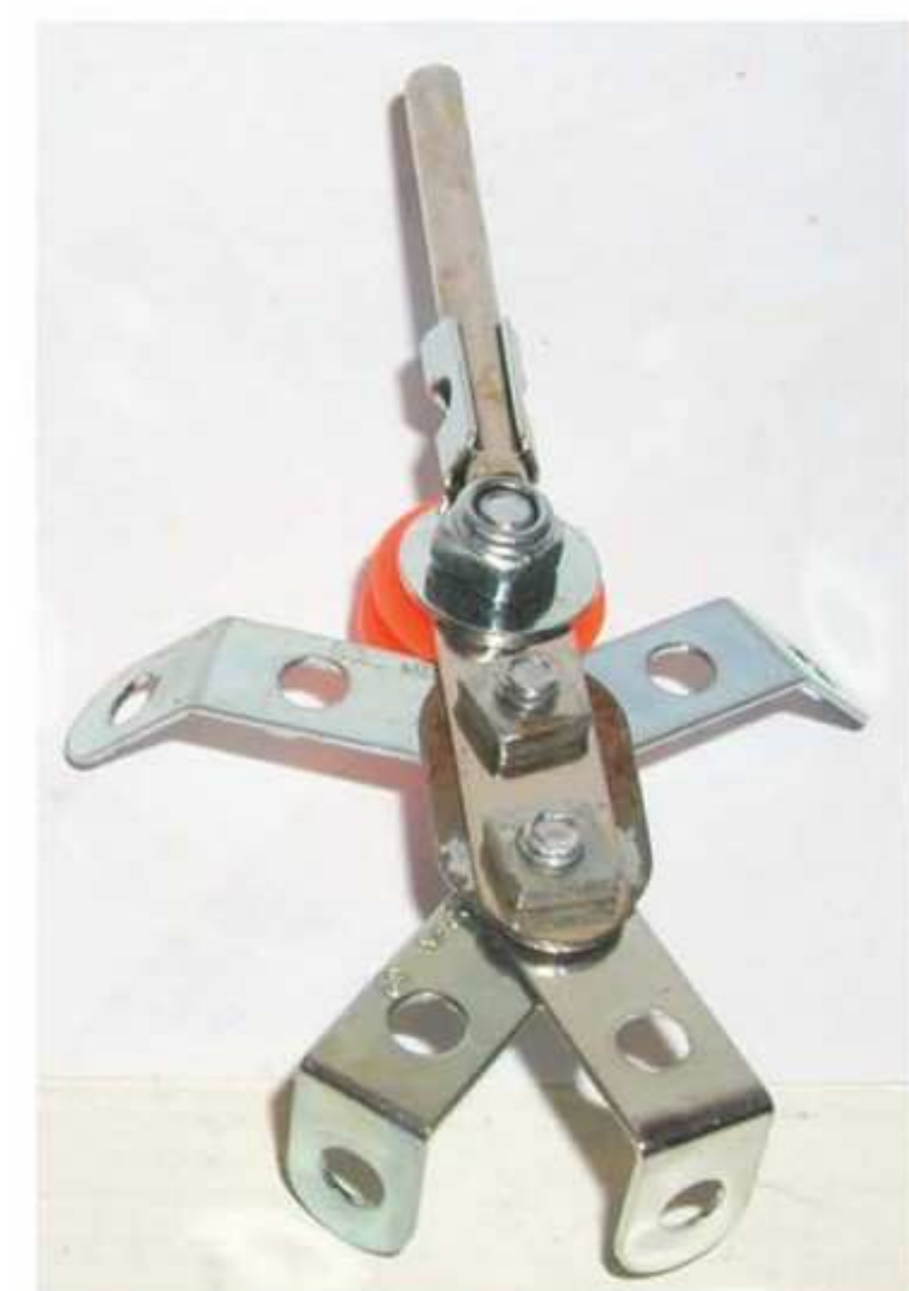
Fig. 5 Les bandes verticales sont des B482 reliées en bas par des N°10 et en haut par des 6a, le tout avec des N°12c. Le reste de la construction ne devrait pas vous poser de difficultés. Motorisation à votre convenance, mais lente.
