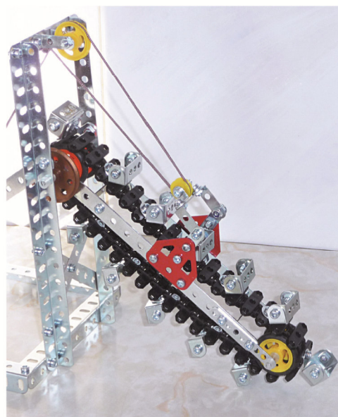
Fig. 23 La chaîne à godets d'une drague
