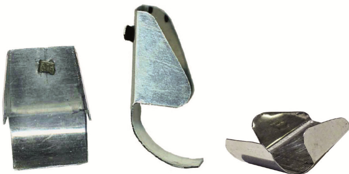
Figs. 21, 22 et 23 Découpe des godets de l'élévateur à billes. Ils doivent être plus ouverts et plus arrondis que le vrai godet de drague Meccano
