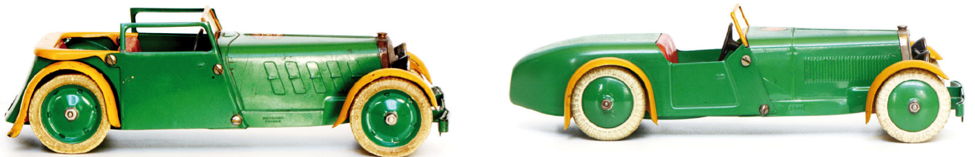
A gauche et ci-dessous, sur les voitures françaises, remarquez les cinq trappes d'aération. A droite, le long du capot, les « crevés » d'aération, communs aux premières voitures, puis apanage des seules anglaises.
