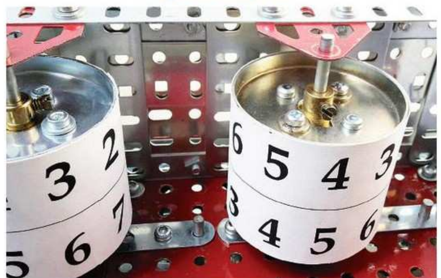
Fig. 10 Les tambours chiffrés vus par dessous
