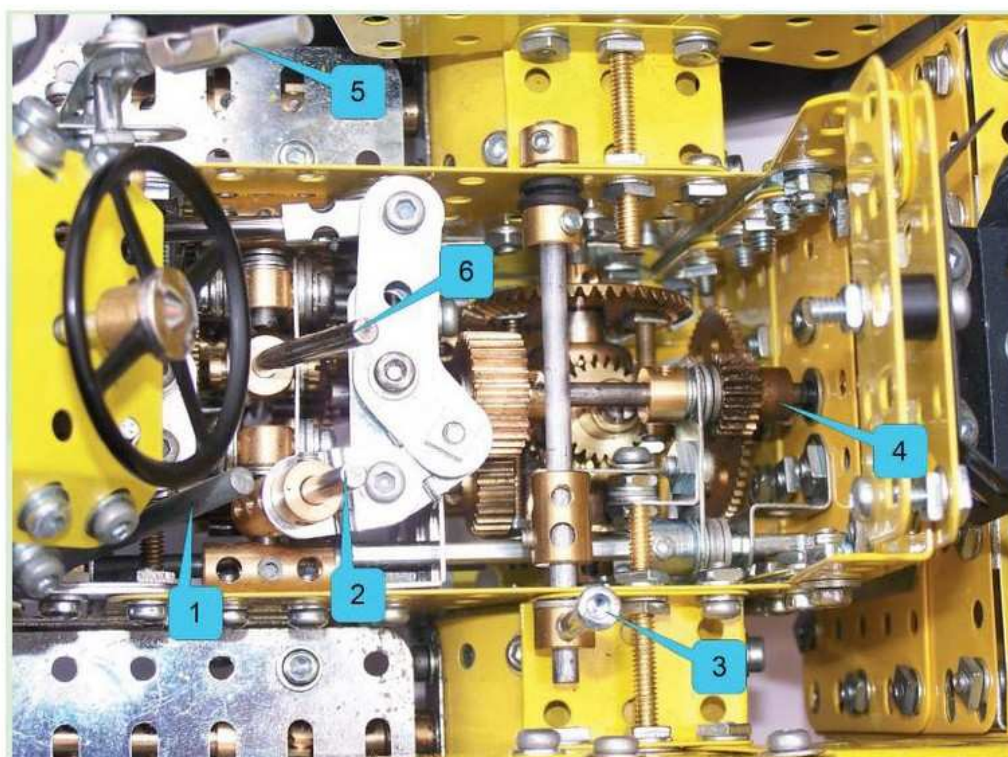
Fig. 6 Le différentiel arrière avec l'arbre de prise de force passant au-dessus. Notez également les charnières réf 114 utilisées pour transmettre le mouvement du levier de gamme Route & Travail
