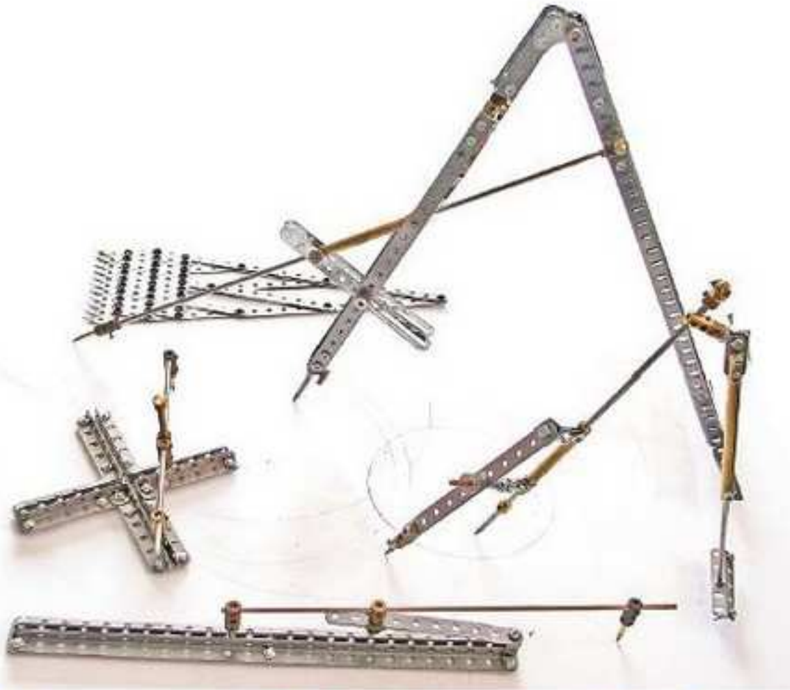
Fig. 1 Les compas de J-P. Guibert : 3 compas à ellipse, 1 compas parfait (toutes coniques), 1 compas diviseur
