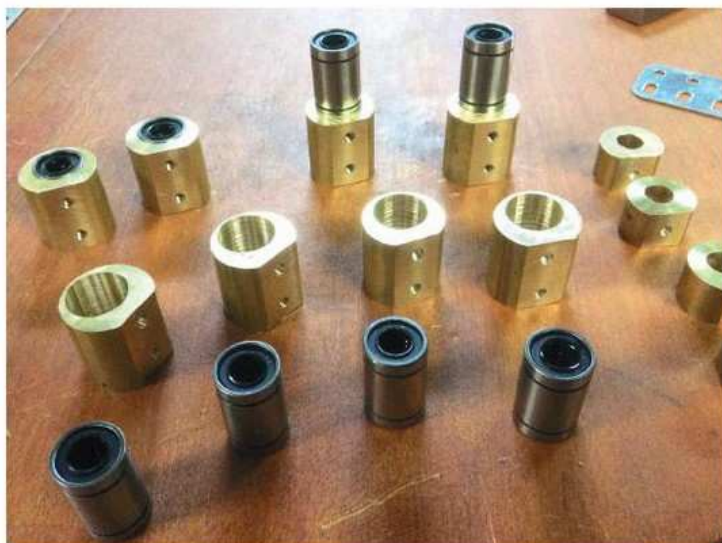
Fig. 3 Pièces en laiton fabriquées pour adapter les roulements à billes linéaires au Meccano
