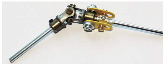
Fig. 6 Sur cette vue, le coulisseau est au minimum et la tringle dépasse à l'intérieur de la chape du cardan. La tringle est bloquée par une vis pointeau montée sur la bague d'arrêt 4 trous. L'entraînement peut être réalisé par deux vis standard (solution économique) ou au mieux par des vis pour cardan réf. 140Z
