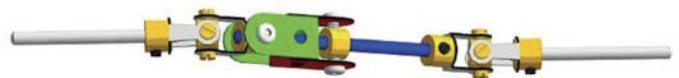
Fig. 2 Autre vue, montrant le support double rouge attaché à la tringle. En position la plus longue, la tringle bleue pénètre au moins dans la totalité de la bague de la chape interne du cardan, pas plus
