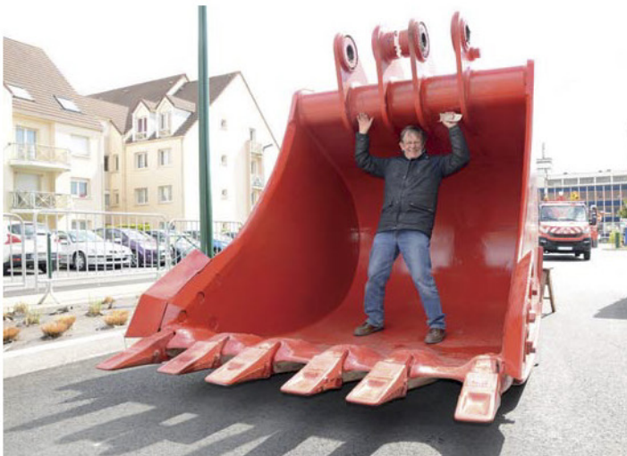
Fig. 10 Bernard teste la résistance du godet de la 1000 (photo 5) dont la capacité va de 5400 à 7200 litres en rétro et 8300 à 10000 litres en version chargeur (idem le modèle Meccano)
