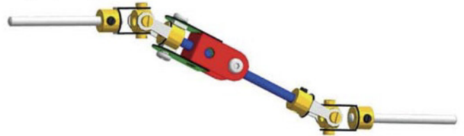
Fig. 1 Le couple est transmis par les deux supports doubles l'un dans l'autre
