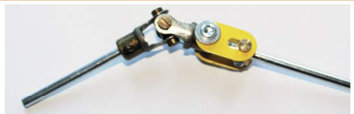
Fig. 5 Le coulisseau est au maximum, les vis se trouvent à l'extrémité des supports plats
