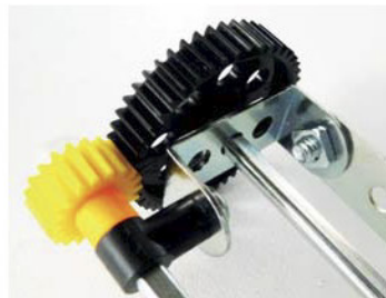
Fig. 4 Deux couplages avec un pignon de 19 dents
