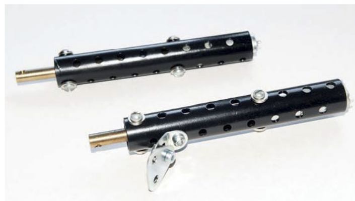
Fig. 5 Modification d'un vérin
