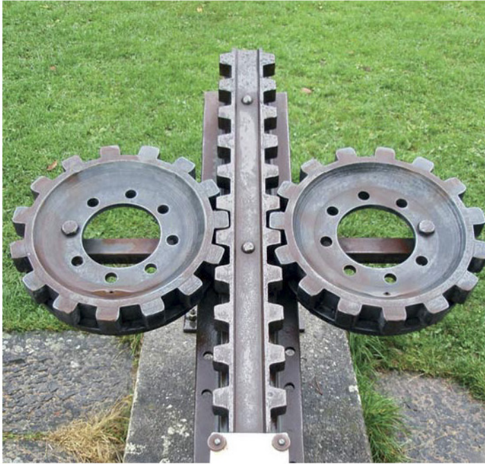
Fig. 1 Le système Locher de crémaillère horizontale
