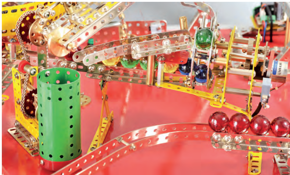
Fig. 13 Vue du godet de la grue automatique et son chargeur de billes
