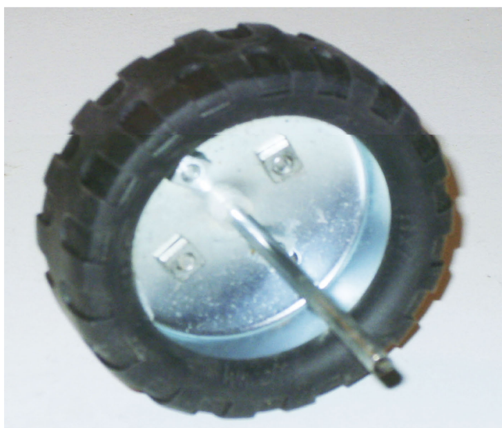
Fig. 7 Joue de chaudière et pneumatique J45
