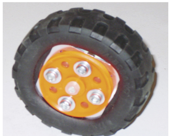
Fig. 9 Montage avec une poulie 21-3P
