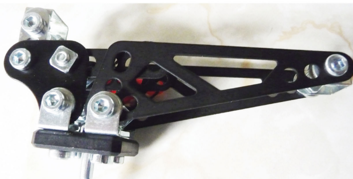
Fig. 28 La partie mobile de la grue, vue de côté
