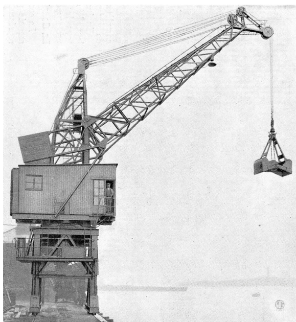
Fig. 1 Grue Stother & Pitt système Topliss
