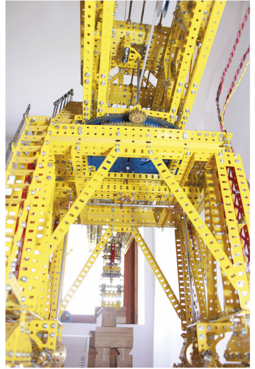
Fig. 8 Détail de la transmission entre la partie supérieure de la flèche et la base. Notez le réducteur utilisé pour la rotation de la flèche
