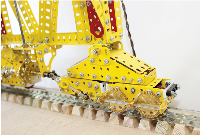
Fig. 6 Les trains roulants avec les coulisseaux montés sur chaque arbre de transmission. Les cardans ont un angle beaucoup moins prononcé que ceux du modèle original
