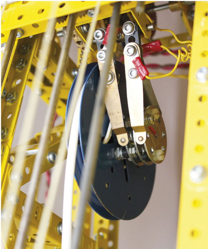
Fig. 16 Gros plan sur l'enrouleur de câble et ses contacts pour la liaison électrique
