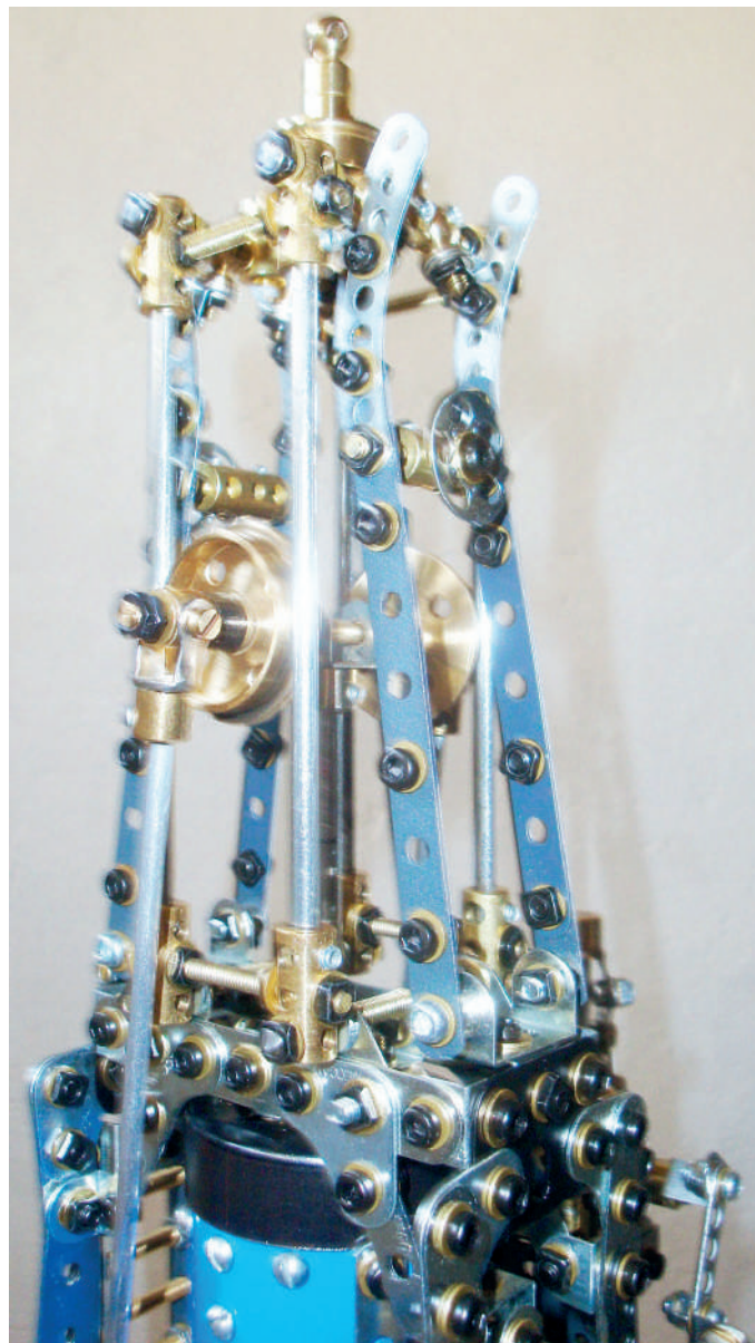
Fig. 7 Glissières et galets de guidage
