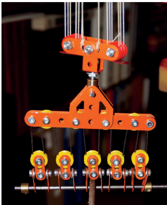
Fig. 9 Un des palonniers associé à ses deux moufles à 16 brins. Moufle qui permet de lever en douceur 2kg sans effort apparent
