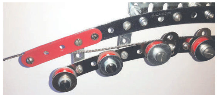
Fig. 13 Support du câble porteur et galets pour le câble tracteur
