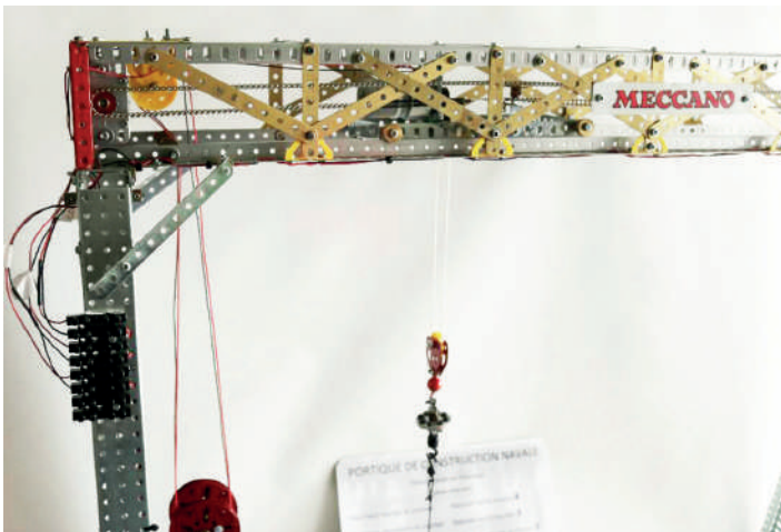
Fig. 8 Liaison électrique pylône-poutre
