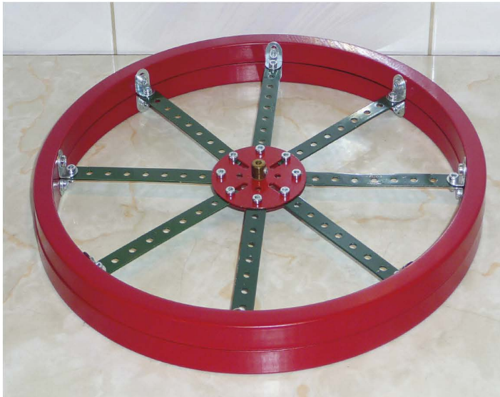
Fig. 2 Un volant fait de deux couronnes
