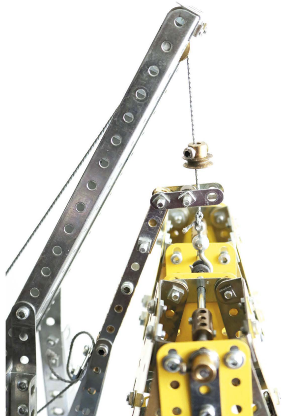
Fig. 6 Flèche après passage sous la poulie
