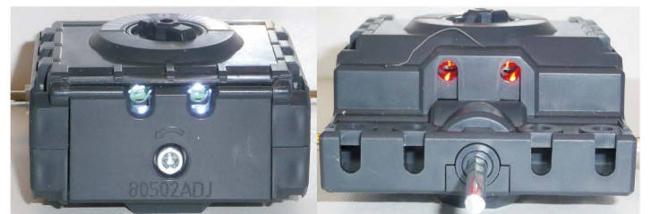
Fig. 7 Les LEDs : blancs à l'avant - rouges à l'arrière
