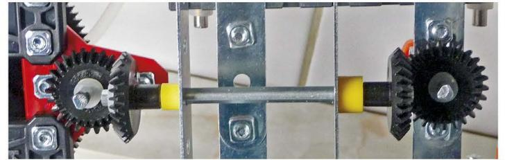
Fig. 5 Commande de rotation du bras
