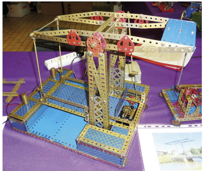
Fig. 4 Le pont levant pouvait être manipulé par les visiteurs ; le moteur et les contacts de fin de course sont cachés dans la base
