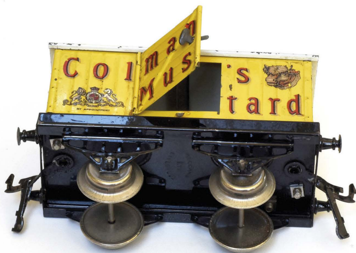
Fig. 2 Porte ouvrante, sa poignée et le montage par deux écrous et boulons
