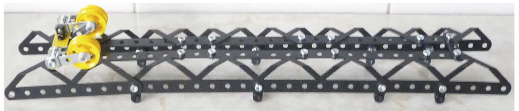
Fig. 11 Le treillis porteur du bras
