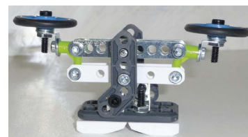
Fig. 4 Balance de Roberval
