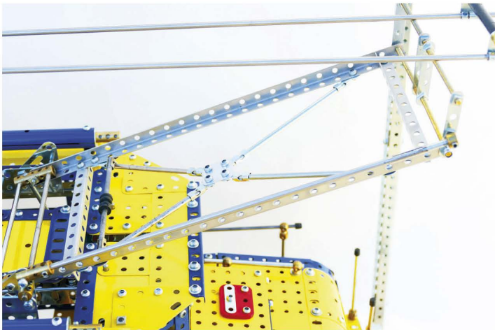
Fig. 8 Les pantographes sont faits de cornières étroites et tringles. Un crochet, non visible sur la photo est relié à la corde fixée sur les plateaux centraux et sur l'axe en bas à gauche entre les deux petites poulies en caoutchouc noir
