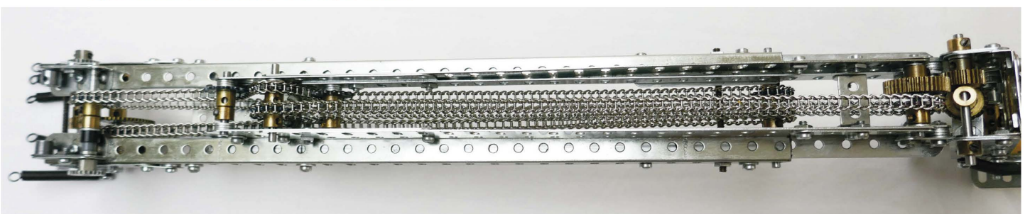
Fig. 7 Manitou, mécanisme du bras télescopique
