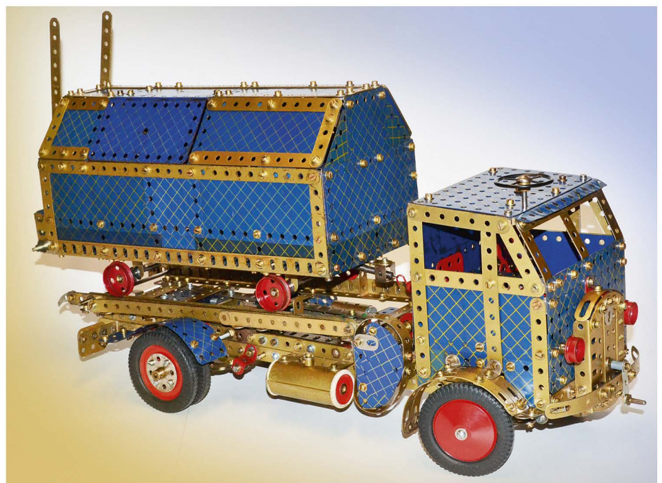
Fig. 3 Les rampes sont rangées, le tout peut prendre la route, le carter visible entre la cabine et le réservoir contient les engrenages pour l'entraînement du treuil
