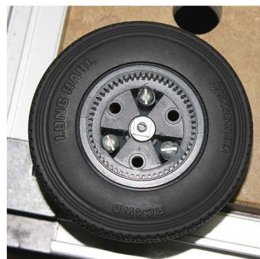
Fig. 22 Détail de montage d'une roue avant
