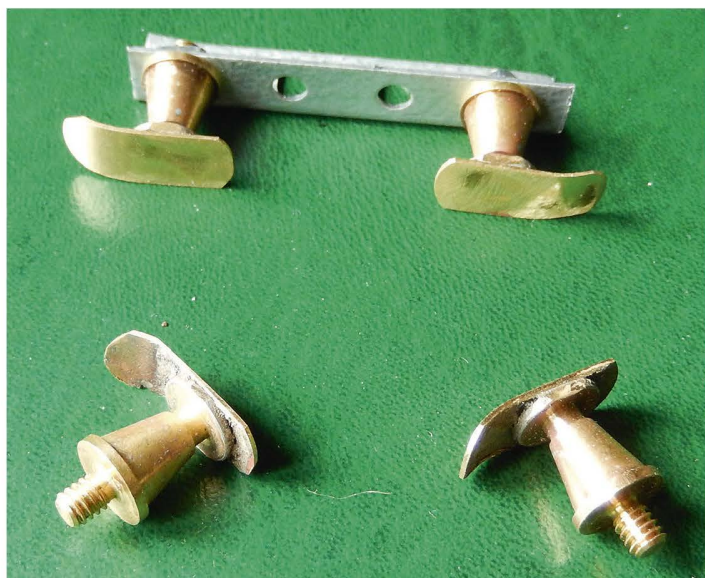
Fig. 7 Modification des tampons
