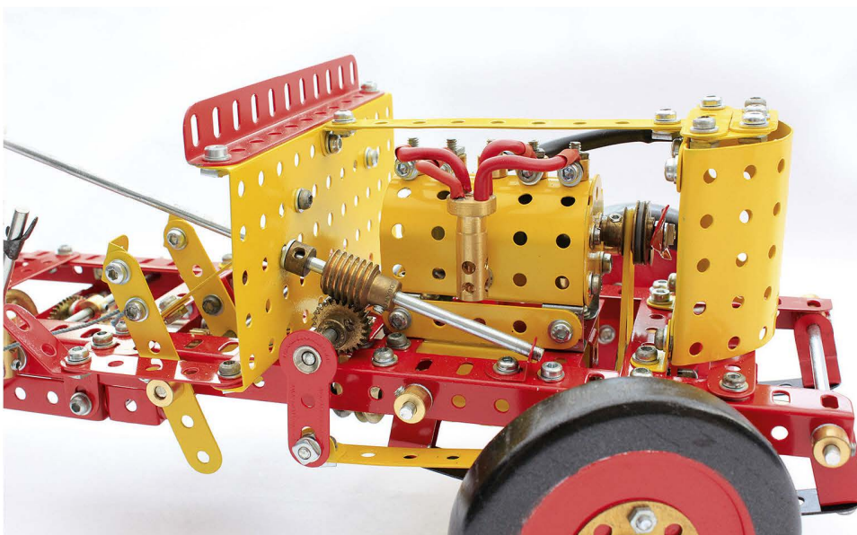
Fig. 9 Vue côté droit montrant le mécanisme de direction, l'allumeur et les fils de bougies
