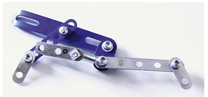
Fig. 17 Mécanisme d'ouverture d'une porte
