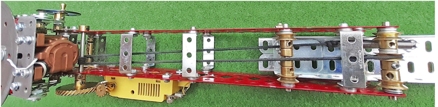
Fig. 17 Le mécanisme de déploiement de l'échelle
