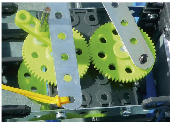
Fig. 15 Roues dentées commandant les déplacements du bras et du chariot
