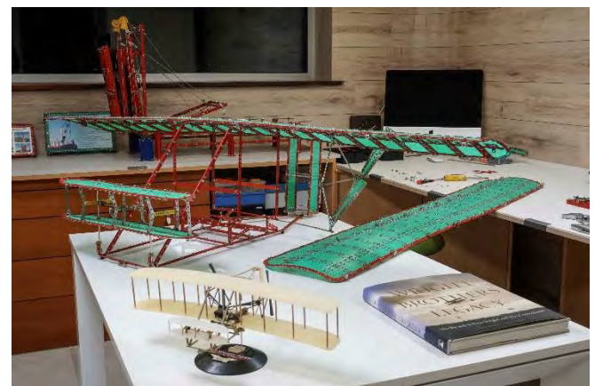
Provisorischer Aufbau des Skelettbauwerks mit dem oberen Flügel
