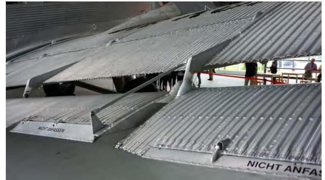
Wellblech - Doppelflügel der Ju 52 mit Ruder- und Landeklappen über die gesamte Spannweite
