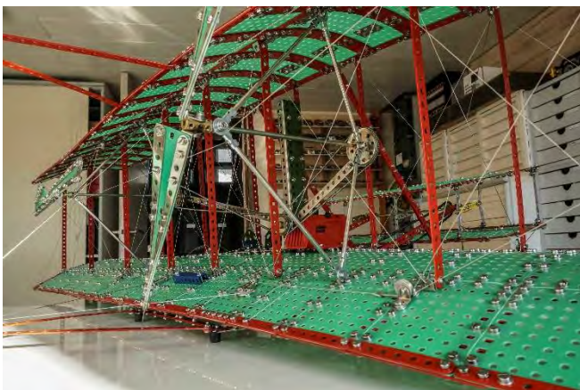
Aufwändige Verspannung mit 0,5 mm Stahlkabeln - beachte die Umlenkrolle für die Flügelverwindung.
