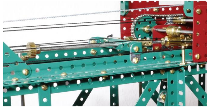
Antrieb 1 und 2: Kette => Ritzel => Schnecke => verschiebbare Welle mit je einem Ritzel und Kronrad zu den beiden Antrieben nach unten.
