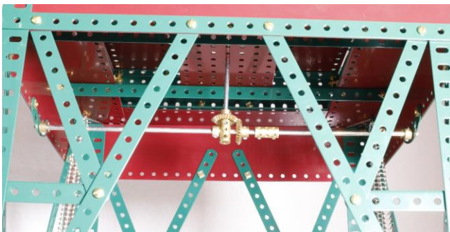
Antrieb zum Verfahren des gesamten Krans - unten
