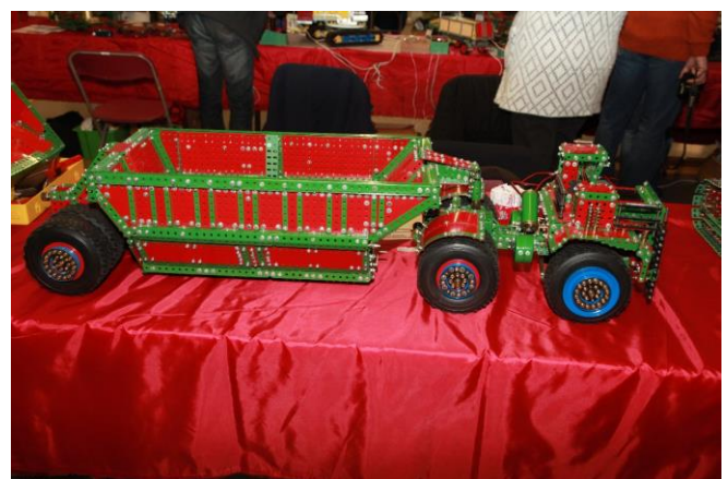
Modell einer Erdbewegungsmaschine (Schürfzug) von Peter Jorges, die durch Allradantrieb, Differenziale und Außenplanetenachsenantrieb beeindruckte. (siehe auch Constructor Quarterly 119 März 2018, Seite 29 und http://www.nzmeccano.com/image-123531 )
