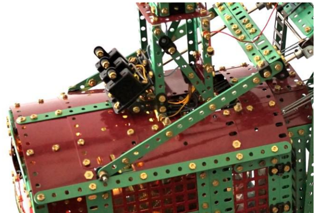
Drei Schalter für Drehen, Greifer, Ausleger
