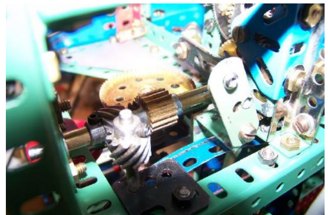
Abb. 4: Ansicht von unten auf die Hauptantriebswelle (untere Welle) – am rechten Bildrand die Halterung für das Wechselrad 45-z/15-z
