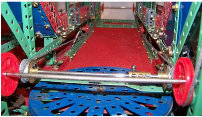
Abb. 12a: Seilantrieb per Schubrollen mit Doppelwindung
