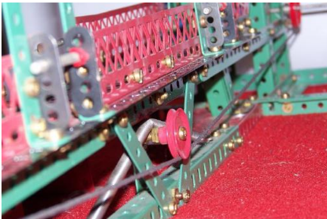
Abb. 12b: vertikal beweglicher, gefederter Zugseilspanner
