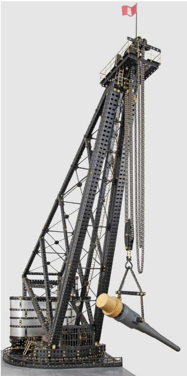
Bild 1: Der „Hamburger Riesenkrahn“ mit 150 t Hebekraft beim Verladen eines Geschützrohres in ein Schiff Links: das 1:32 Modell Rechts: Postkartenfoto von ca. 1906
