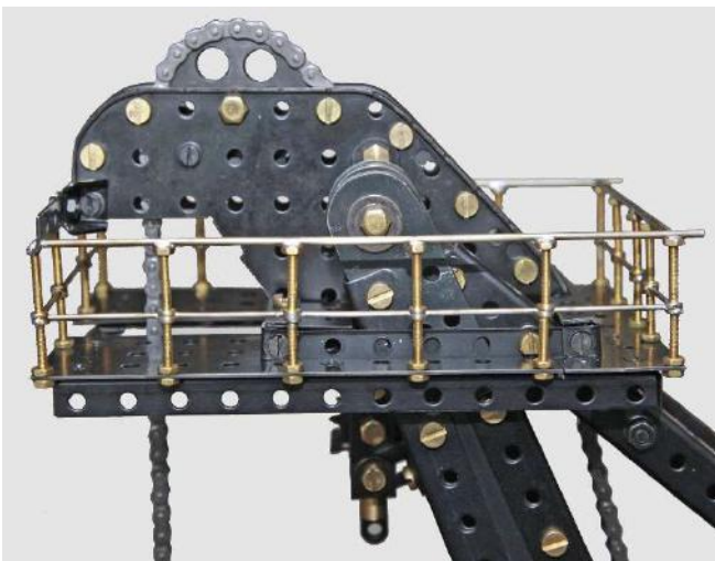
Bild 21: Zusammenbau der Zugstrebe aus zwei Längsträgern und Wellen mit Endgewinden zur Querverbindung. Die FAC Klemmschellen dienen zur Befestigung der Diagonalversteifungen.
