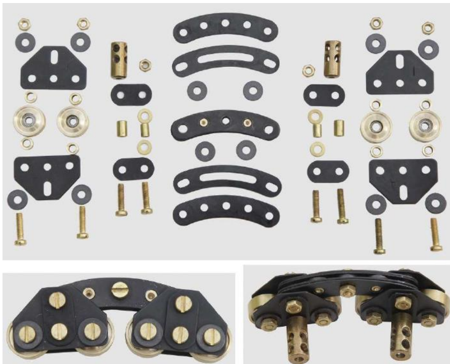
Bild 11: Laufgestell-Paar und seine Einzelteile.
