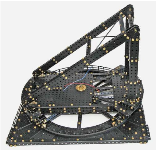
Bild 19: Drehscheibe mit dem starken Kran-Grundgerüst, an das der starre Ausleger mit Bolzen angeschlossen wird.
