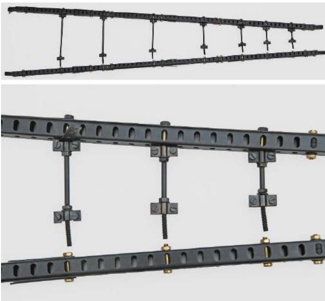
Bild 21: Zusammenbau der Zugstrebe aus zwei Längsträgern und Wellen mit Endgewinden zur Querverbindung. Die FAC Klemmschellen dienen zur Befestigung der Diagonalversteifungen.
