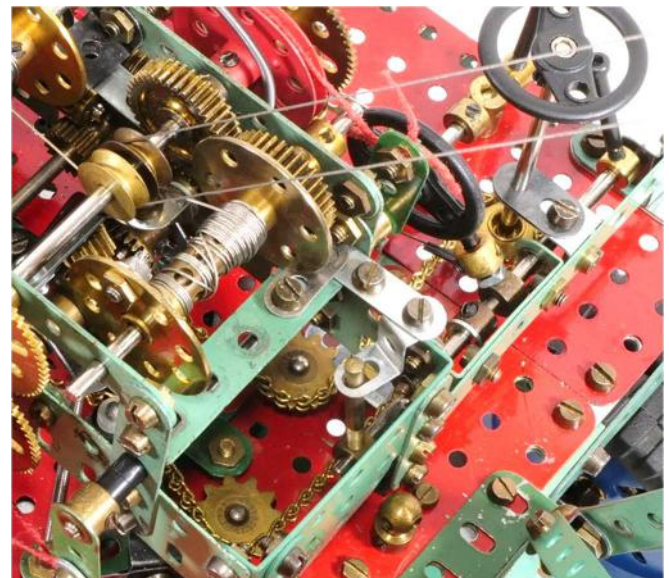
Fig. 10 Lenkrad mit Kettentrieb
