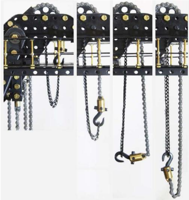
Bild 26: Einhängvorgang des Nebenhakens zur Bildung einer Schlaufe als Kettenspeicher.
