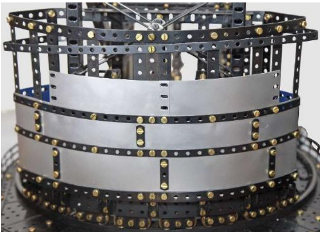
Bild 32: Gegengewicht-Sandbehälter im Aufbau.
