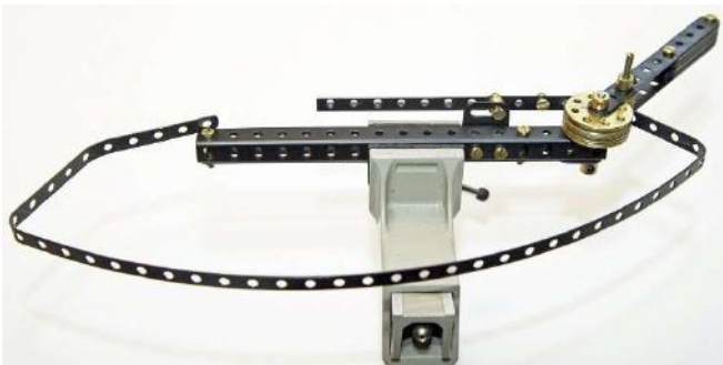
Bild 33: Mit dieser einfachen Biegevorrichtung wurden die Reifen des Behälters gebogen.
