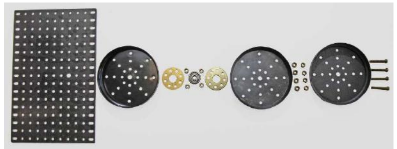
Bild 16: Aufbau des Drehlagers für den Mittelzapfen.
