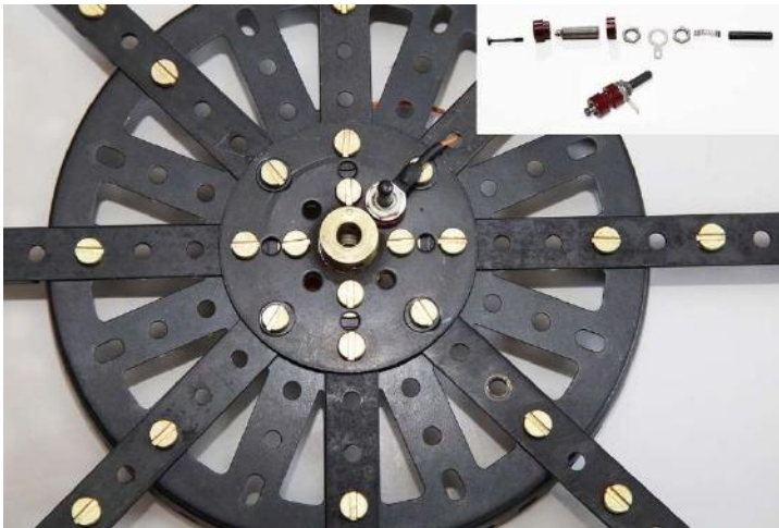
Bild 5: Drehzapfen-Aufnahme und Schleifkontakt.
