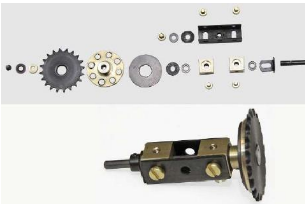
Bild 15: Drehantrieb mit magnetischer Rutschkupplung.
