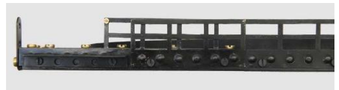
Bild 8: Geländer mit Schiebetor.
