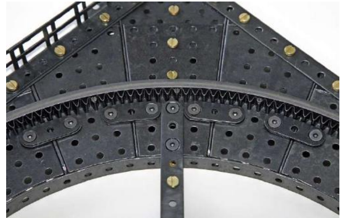
Bild 7: Befestigung des Zahnkranzes an der Schienen-Innenseite.
