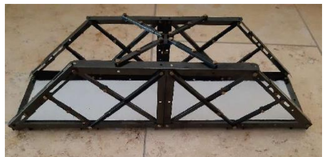
Typisches Modell einer Fachwerkbrücke, bei dem die Vorteile der längenverschieblichen Trägerelemente gut zu sehen sind. Jede schräge Verstrebung ist aus derartigen Elementen zusammengesetzt.
