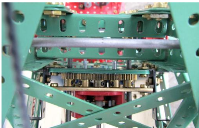
Märklin 1071 Motor mit Antrieb der Gewindespindeln
