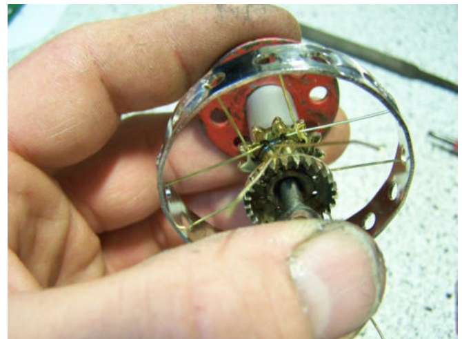
Abb. 32: Anpressen der eingesteckten, gekreuzten Speichen
