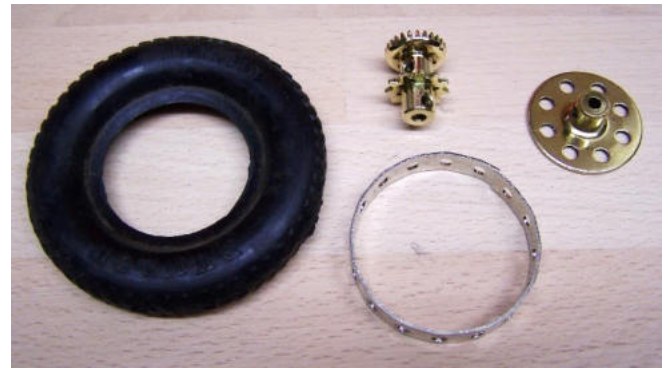
Abb. 13: Einzelteile - Nabe zusammengelötet
