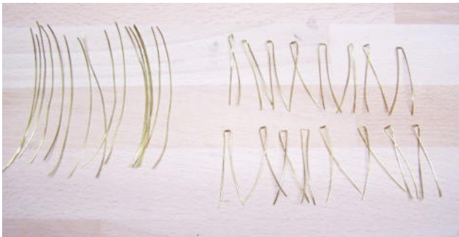
Abb. 17: 16 Stück Speichen, roh und gebogen
