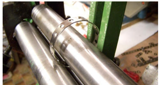
Abb. 7: Runden des Felgenrohrlings
