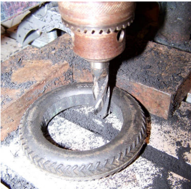
Abb. 50: Bearbeitung des Reifens - Entfernen des inneren Grates
