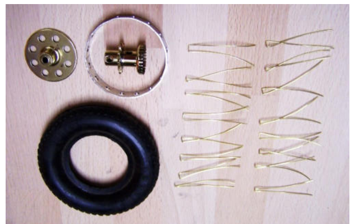
Abb. 16: Einzelteile gebohrt, gerundet, gelötet und poliert mit gebogenen Speichen
