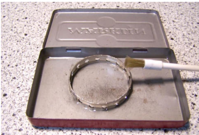
Abb. 10: Reinigen nach dem Lötten mit Waschbenzin
