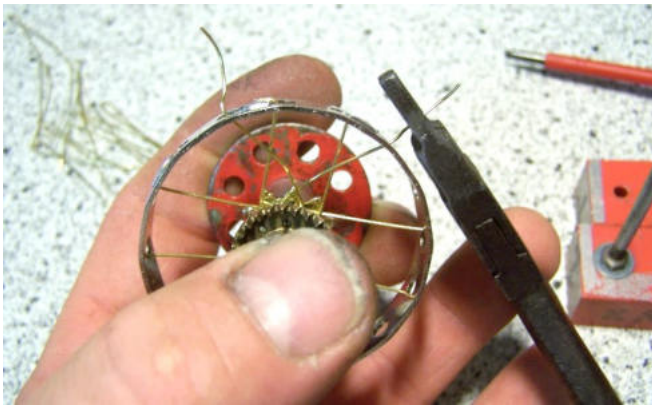
Abb. 34: Einziehen der neu eingefädelten Speichen
