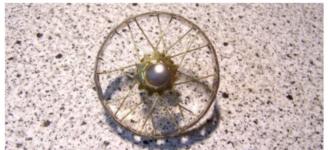
Abb. 46: Zweite Seite - die ersten 4 Speichen eingelötet - von vorn
