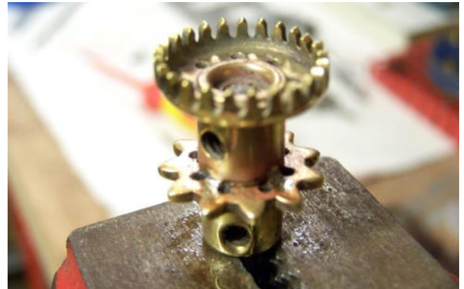
Abb. 14: Lötten der Nabe mittels Flussmittel, Lötzinn und eines Propangasbrenners
