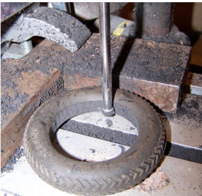
Abb. 51: Einfräsen einer Nut zur Aufnahme des Löt- wulstes der Felge
