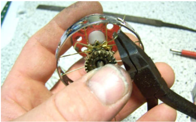
Abb. 33: Einfädeln der gekreuzten Speichen
