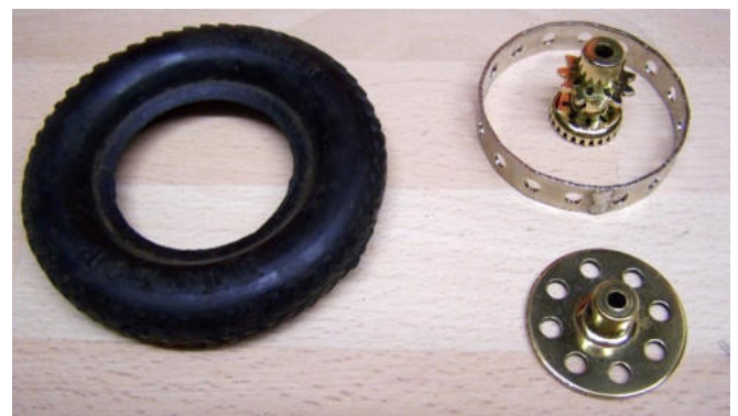
Abb. 15: Einzelteile gebohrt, gerundet, gelötet und poliert
