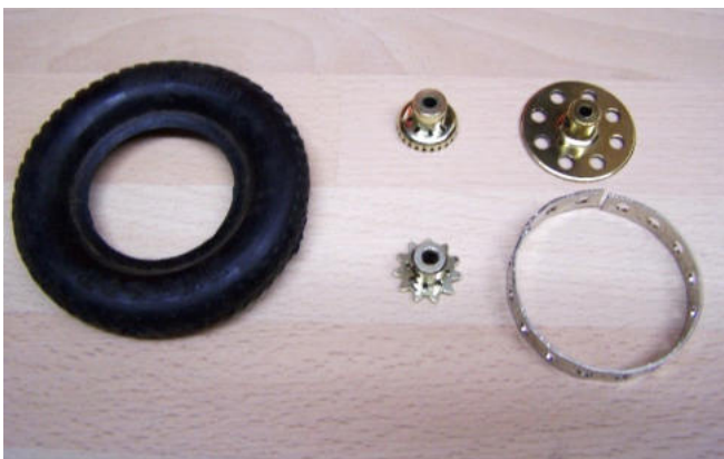
Abb. 12: Einzelteile gebohrt, gerundet und poliert
