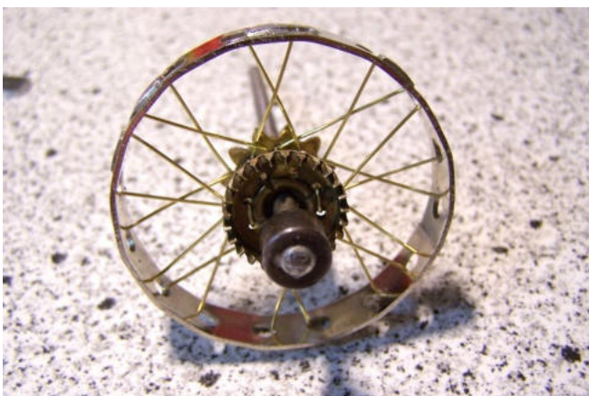
Abb. 44: Zweite Seite - die ersten 4 Speichen eingelötet - von hinten
