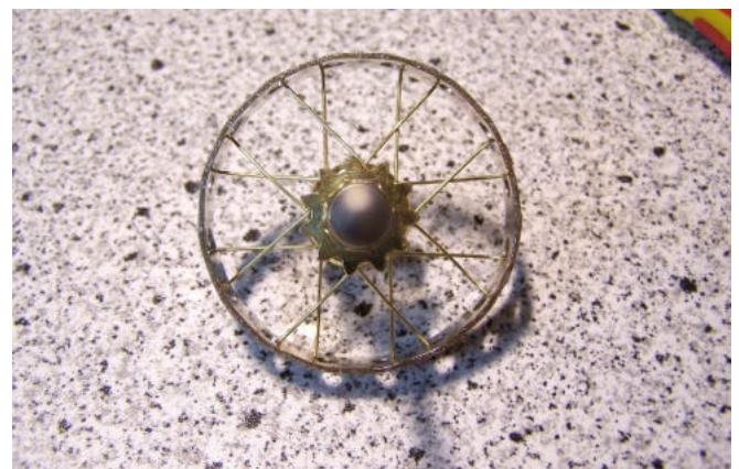
Abb. 40: Felge erste Seite fertig eingespeicht und gelötet
