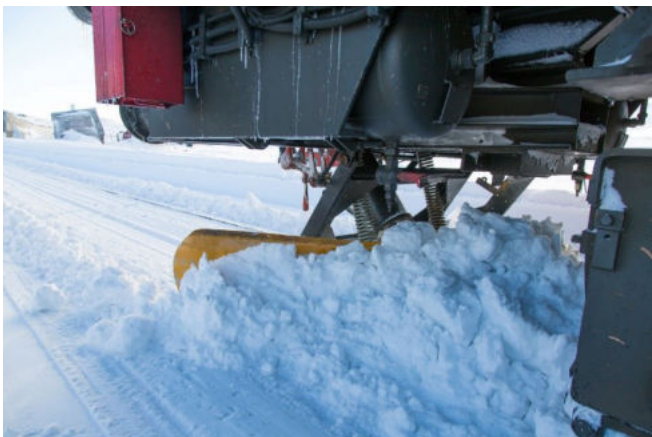
Bild 16a Der Originalpflug räumt den Schnee zwischen den Schienen Bild Aebi Schmidt Group
