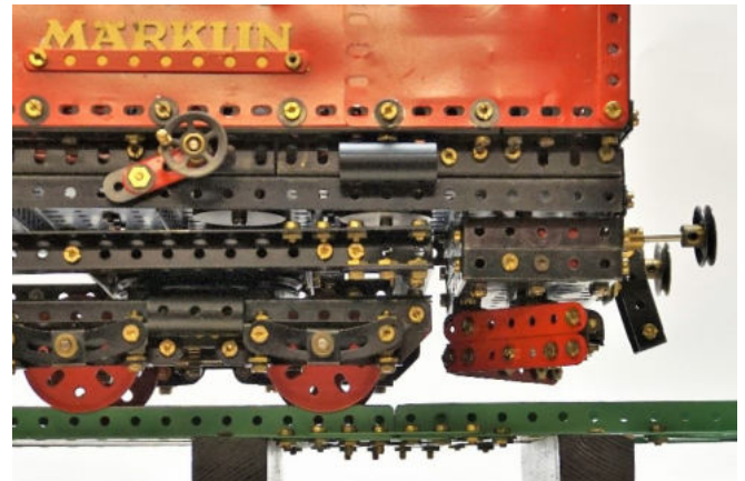
Bild 16b Die Profilpflugschar unter dem Heck (angehoben)
