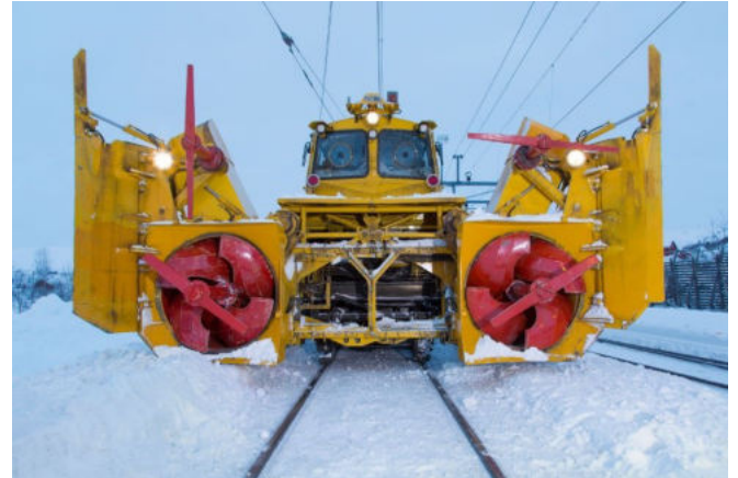
Bild 14 d Vorbauhälften, voll ausgefahren mit Raffelblechen links und rechts außen, zwei Wurfträgern und vier Schneidepropellern, Bild Aebi Schmidt Group
