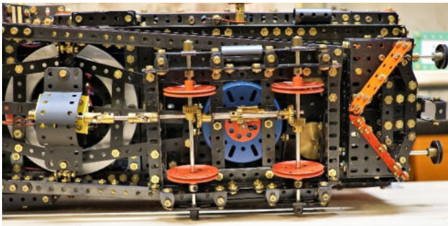
Bild 10 Fahrt voraus: Kraftübertragung über zwei Kegelhäder, zwei Ritzel und je zwei Kronräder/Ritzel auf zwei Achsen
