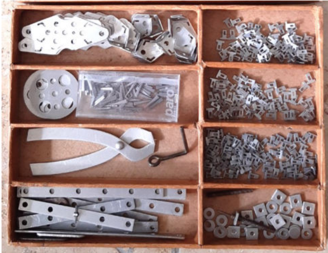
Inhalt des Baukastens mit Konstruktionsteilen links und Verbindungselementen rechts. Die Kunststoffdose mit den Keilen ist nicht zeitgemäß.
