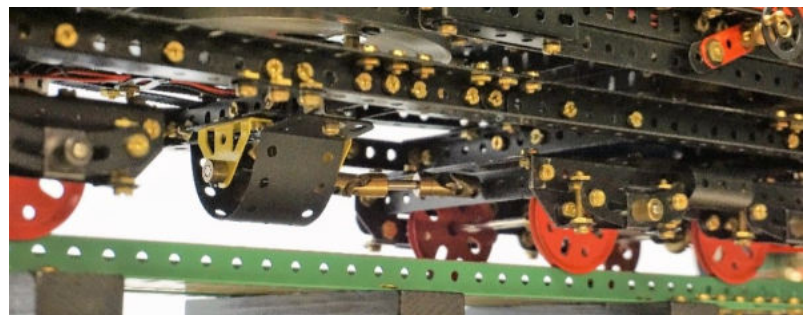
Bild 9 Antriebsstrang durch den Drehteller zum hinteren Drehgestell
