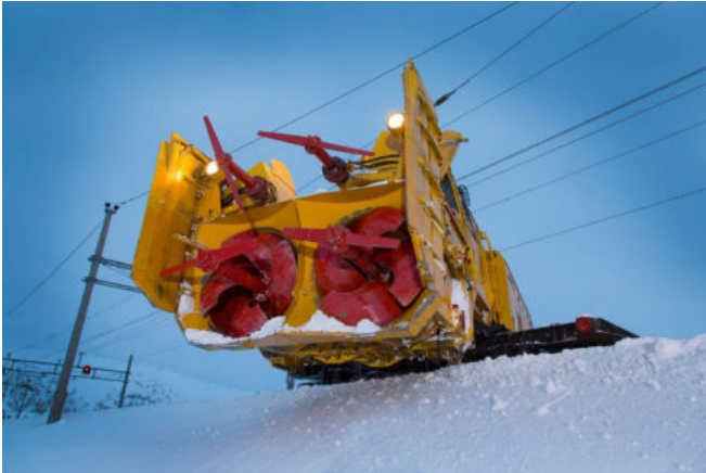
Bild 14 a Die Original-Schneesleuder dreht auf ihrem Fahrgestell bei geschlossenem Schleudervorbau, Bild Aebi Schmidt Group
