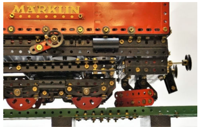
Bild 16b Der Profilpflug im Modell (abgesenkt)
