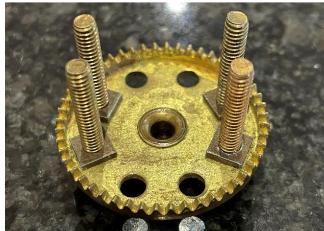
Abb. 4.3 Differenzial, Kronrad mit Gewindestangen für den Umlauftrüger
