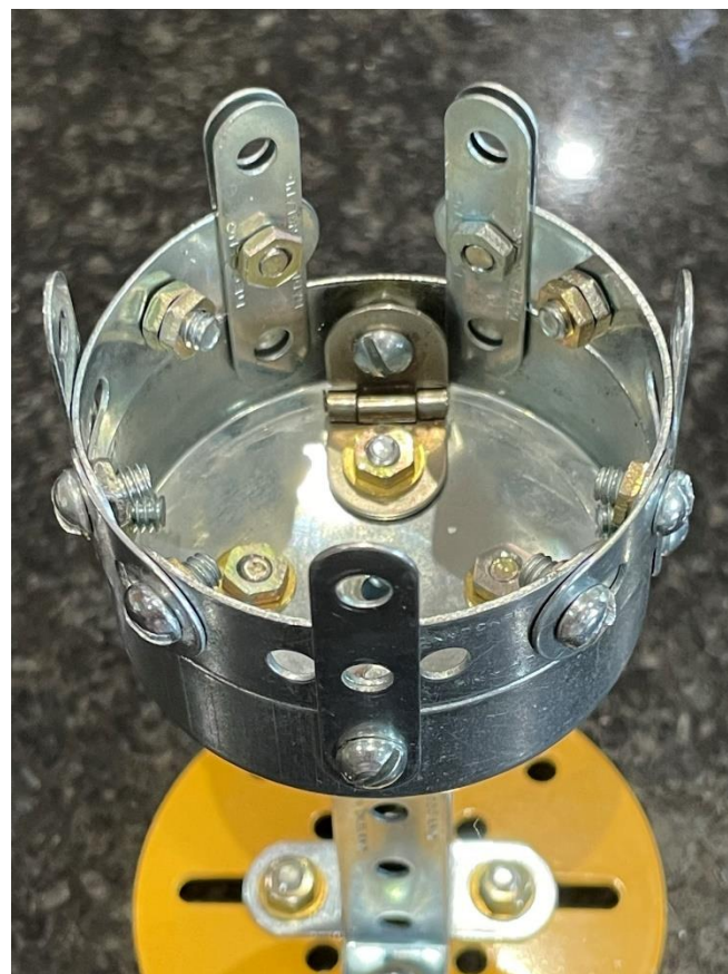
Abb. 3.5 Distanzstück in Boiler End eingesetzt
