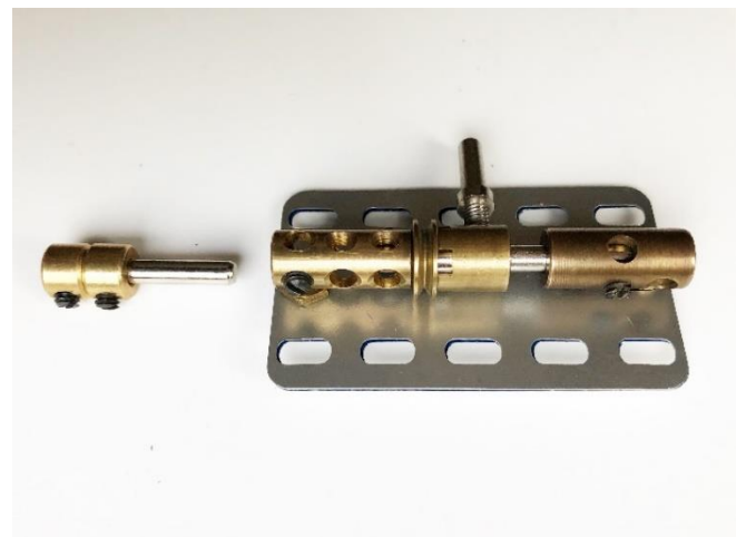
Schritt 1: kurze Achse mit 2 Stellringen wird entnommen
