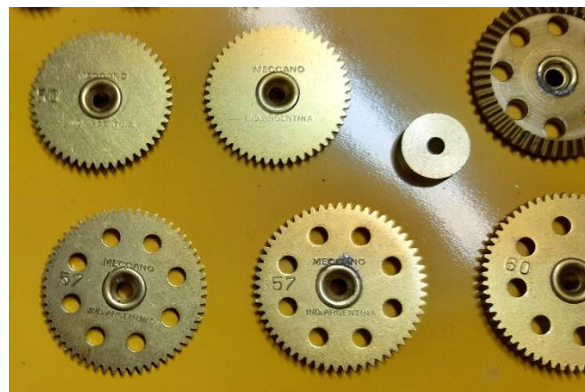
Fig 11 Stempelung der Messingteile
