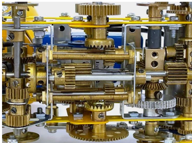
Bild 5: Steuerwelle horizontal mittig und Satellitenräder, rechts senkrecht Antriebswelle der Beine, links senkrecht Zwischenwelle für Kopfdrehen
