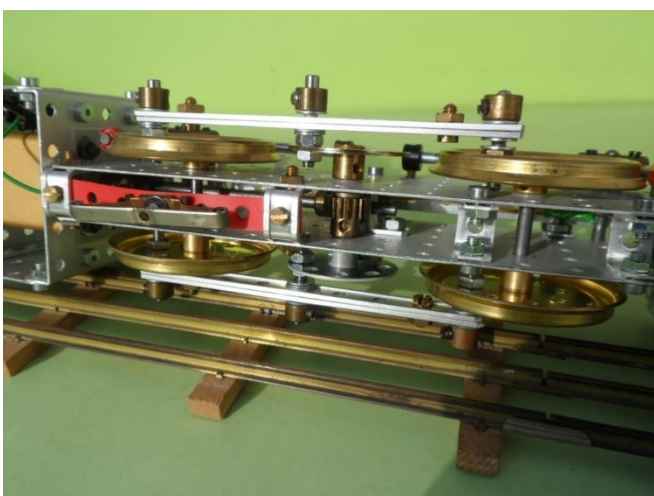
Ansicht der Grubenlok von unten mit Stromabnehmer für die Mittelschiene
