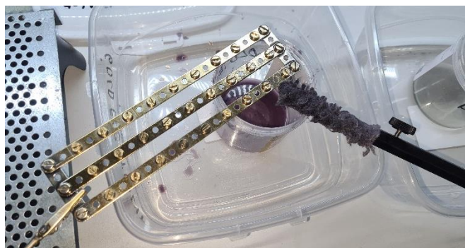
Vergolden der Schrauben: links Elektrode an der Krokodilklemme, rechts Elektrode an der Bürste
