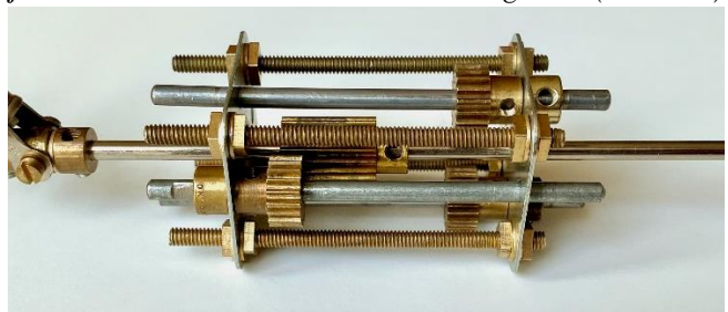
Bild 6: Prototyp sequenzielles Getriebe, Steuerwelle und drei Satellitenräder
