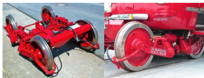
Original-Spurwagen mit Drehzapfen, vier Auflagepunkten und Bremsanlage Fotos Oliver Pelst (l.) und Michael Baier (r.)
