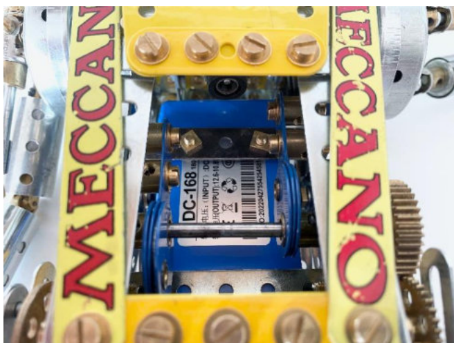
Bild 22 Ladebuchse unter der Frontabdeckung oben im Bild. Darunter die beiden Exzenter. Hinten der Akku von innen gesehen
