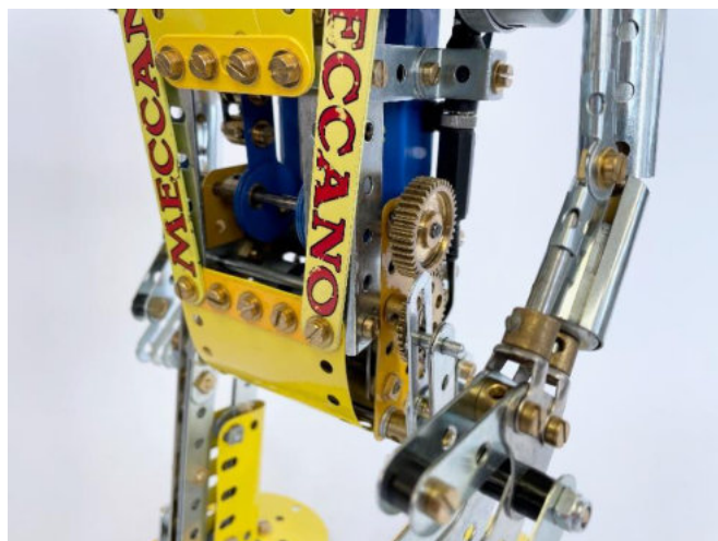
Bild 8 Durch eine Aussparung im Bauch des Roboters sind die beiden Exzenter zu sehen
