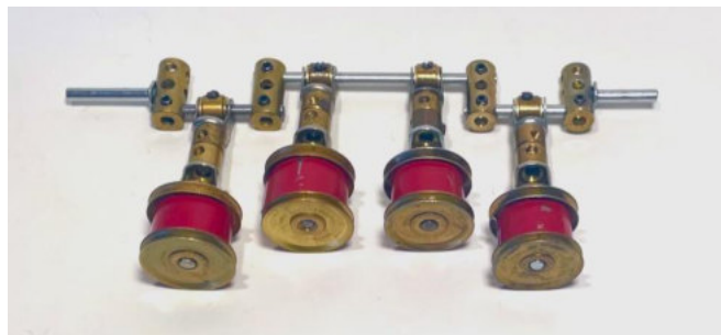
Bild 06 fertiger Motorblock vor dem Einsetzen der Kurbelwelle
