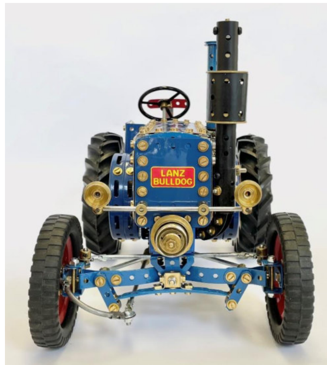
Bild 20 In der Bildmitte der Glühkopf aus verschiedenen gestapelten Schnurlaufrollen
